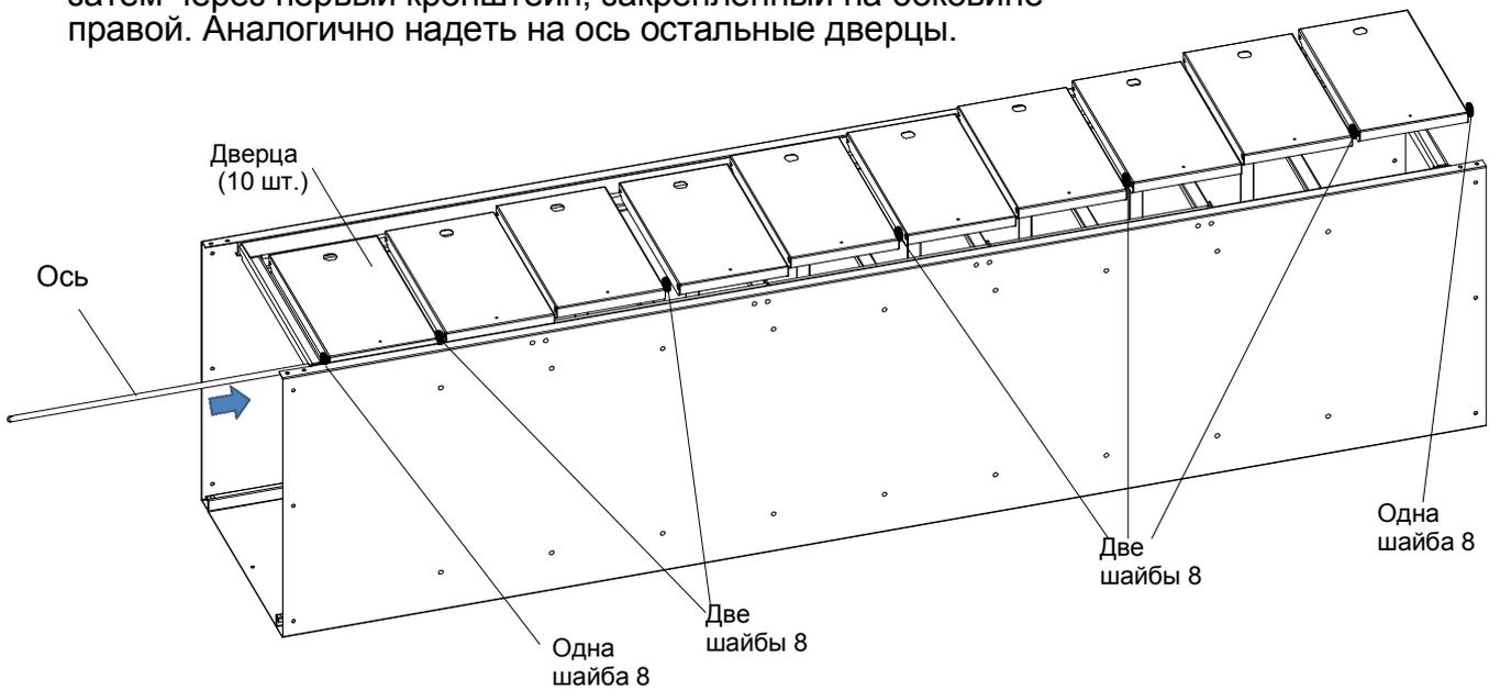
После установки всех дверец, надеть на ось шайбу 8, пропустить ось через оставшееся отверстие в двери общей и с обеих сторон оси надеть по одной шайбе 8.
