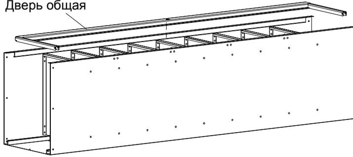
Завести в отверстия двери общей с одной из сторон ось, надеть на ось шайбу 8, далее пропустить ось через одну дверцу, надеть на ось две шайбы 8, пропустить ось через следующую дверцу, затем через первый кронштейн, закрепленный на боковине правой. Аналогично надеть на ось остальные дверцы.
