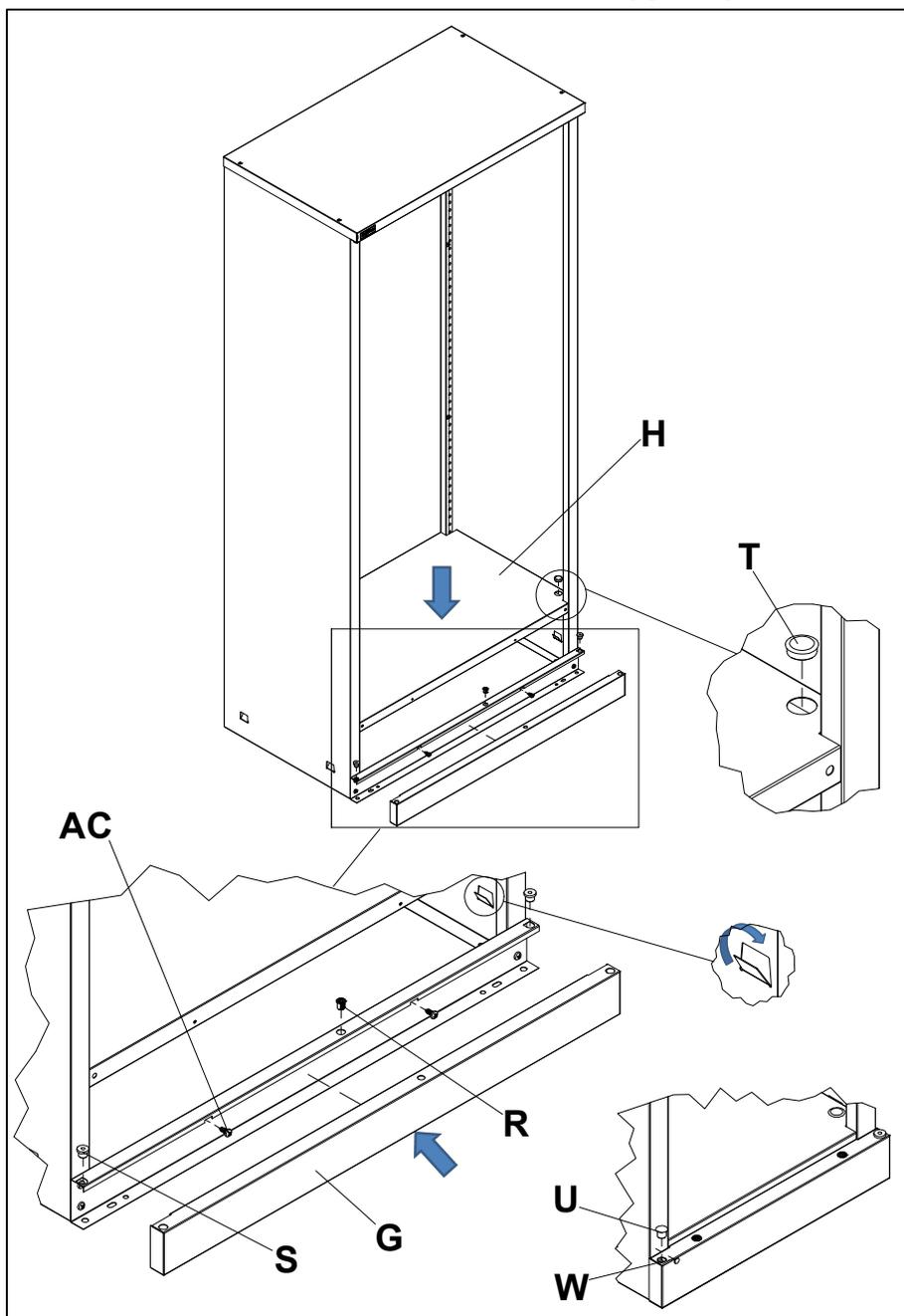
Установить днище **H** в зацепы на стенках, а затем зафиксировать его при помощи саморезов **AC** (5,5x16). Вставить панель нижнюю **G** в панель крепёжную. Установить втулки **S**, а также фиксаторы направляющих **R**. **Внимание!** При сборке шкафа **РАЦИОНАЛ-16** установить заглушки **U**, а также демпферы самоклеющиеся **W** со стороны установки замка на дверь.
