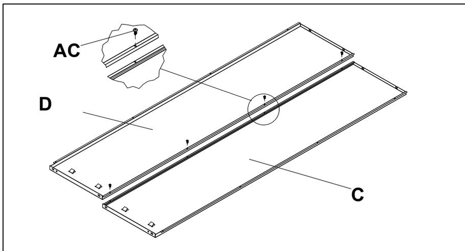
Установить стенку заднюю левую **D** на стенку заднюю правую **C** при помощи саморезов **AC** (5,5x16).
