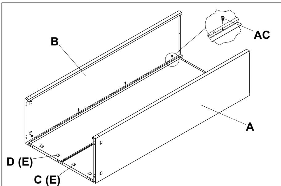
Установить стенки задние на стенки боковые **A**, **B** при помощи саморезов **AC** (5,5x16).
