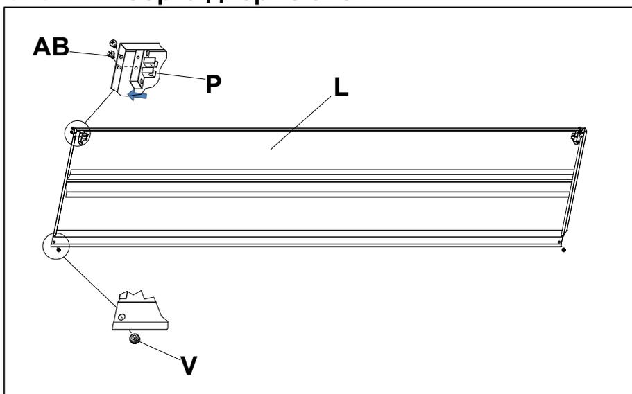
Установить петли пластиковые **Р** внутрь двери левой **Л** при помощи саморезов **АВ** (4,2x9,5). Установить упоры резиновые двусторонние **В**.
