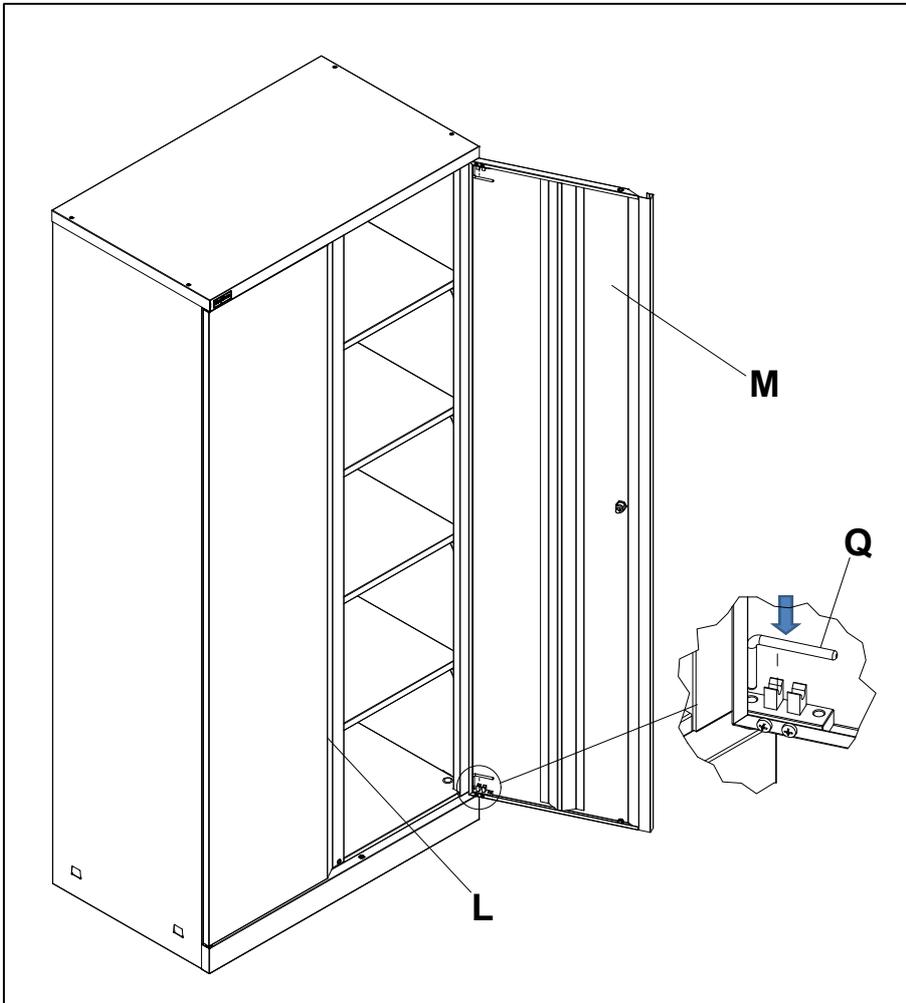
Установить двери в шкаф, защёлкнув оси **Q** в петли пластиковые и вдев их во втулки.
