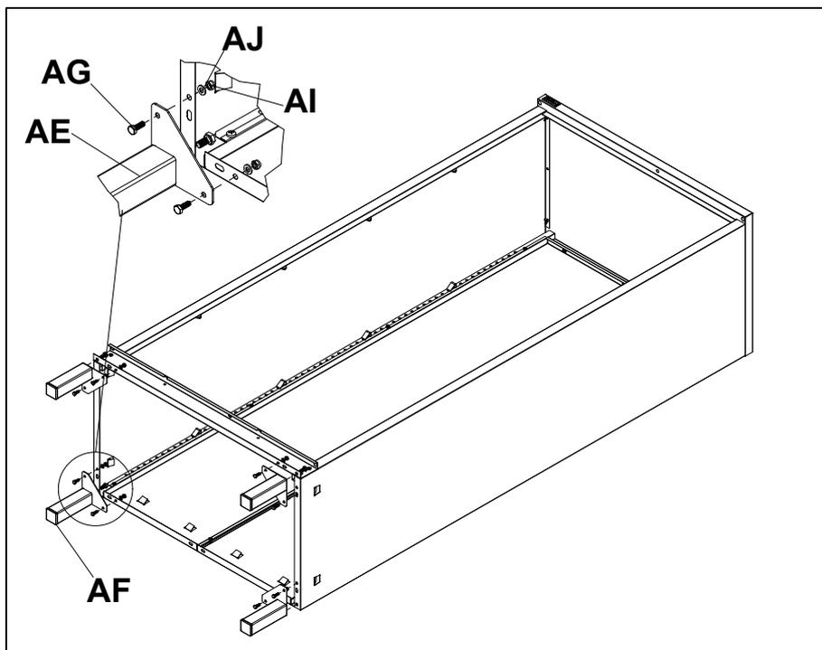
Установить ножки **AE** с заглушками **AF** под шкаф при помощи болтов **AH** (M6x16), шайб **AJ** и гаек самоконтрящихся **AI**, а также при помощи болтов **AH** (M8x16).
