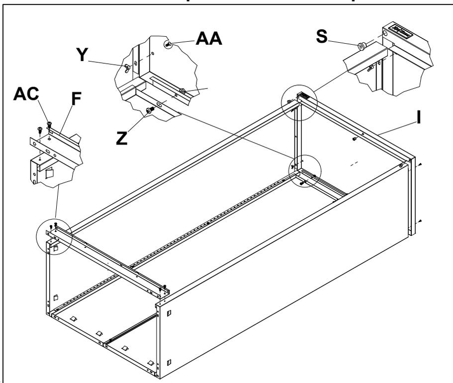
Установить крышку **H** на стенки задние и на стенки боковые при помощи полупотайных винтов **AA** (M4x10) и гаек **Y**. Установить панель крепёжную **F** при помощи саморезов **AC** (5,5x16) на стенки боковые.
