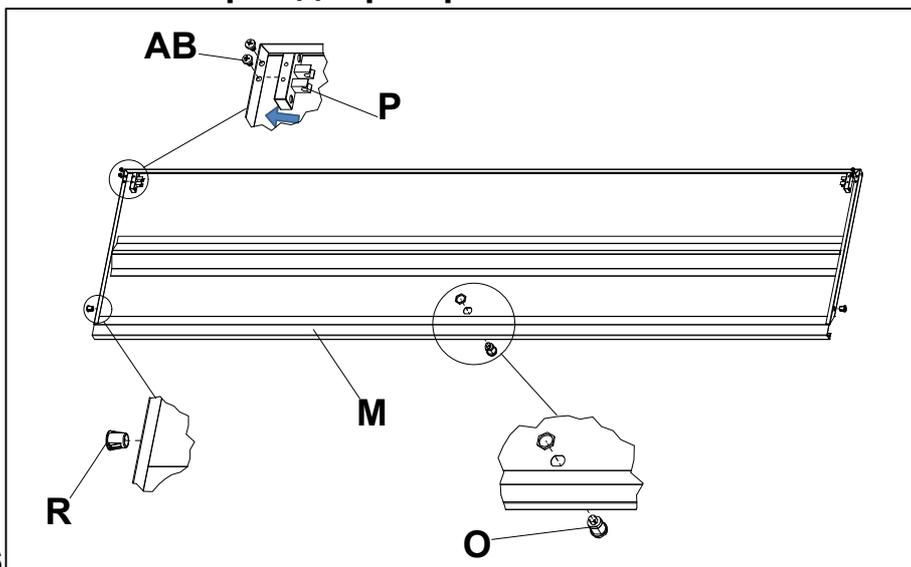
Вставить петлю пластиковую **Р** внутрь двери правой **М** при помощи саморезов **АВ** (4,2x9,5). Установить фиксаторы направляющей **Р**. Установить корпус замка **О**.
