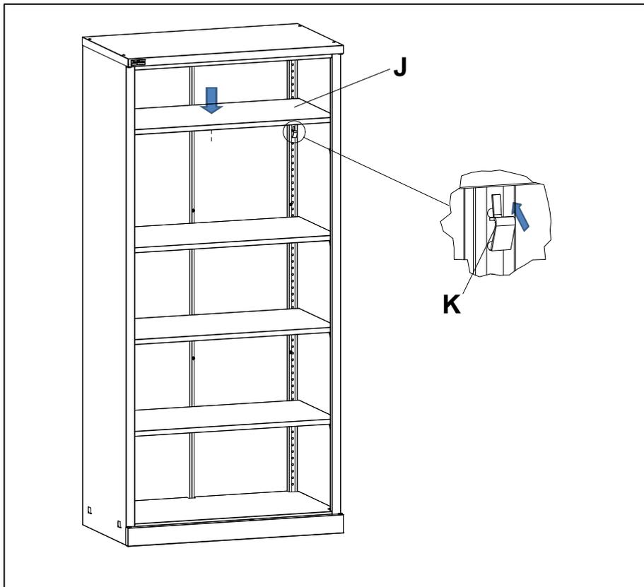
Установить полки **Ж** при помощи опор **К**. По желанию Покупателя можно установить дополнительные полки.
