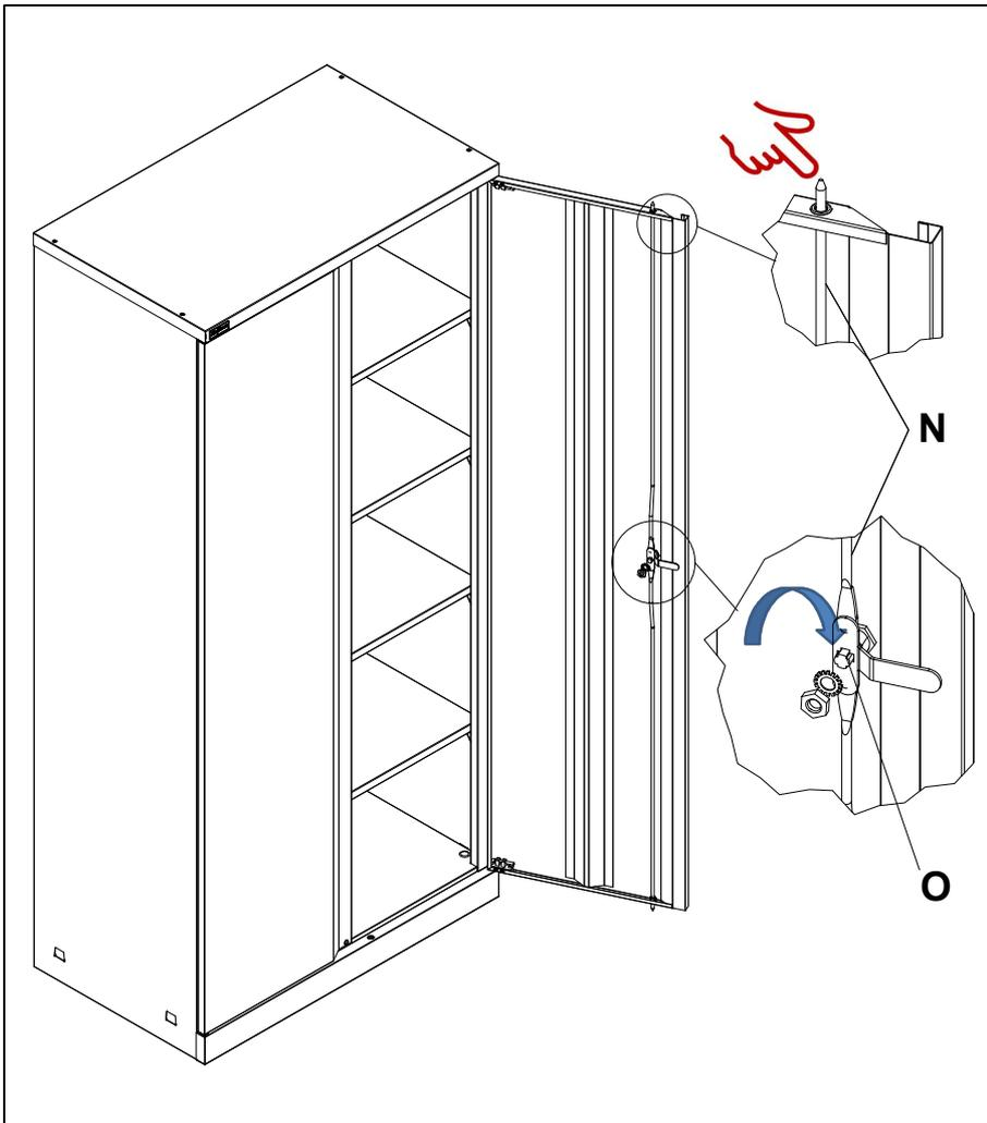
Установить тяги **N** на замок **O**. Зафиксировать тяги в положении "закрыто". Тяги должны входить в фиксаторы направляющих.
